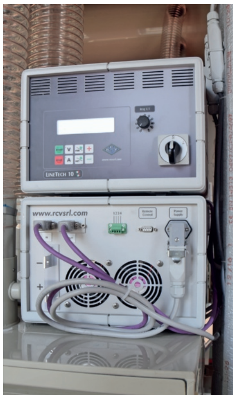
Vista del nuovo impianto a telaio statico in Bedin Galvanica, dove sono stati integrati i nuovi raddrizzatori R.C.V. Line Tech.
