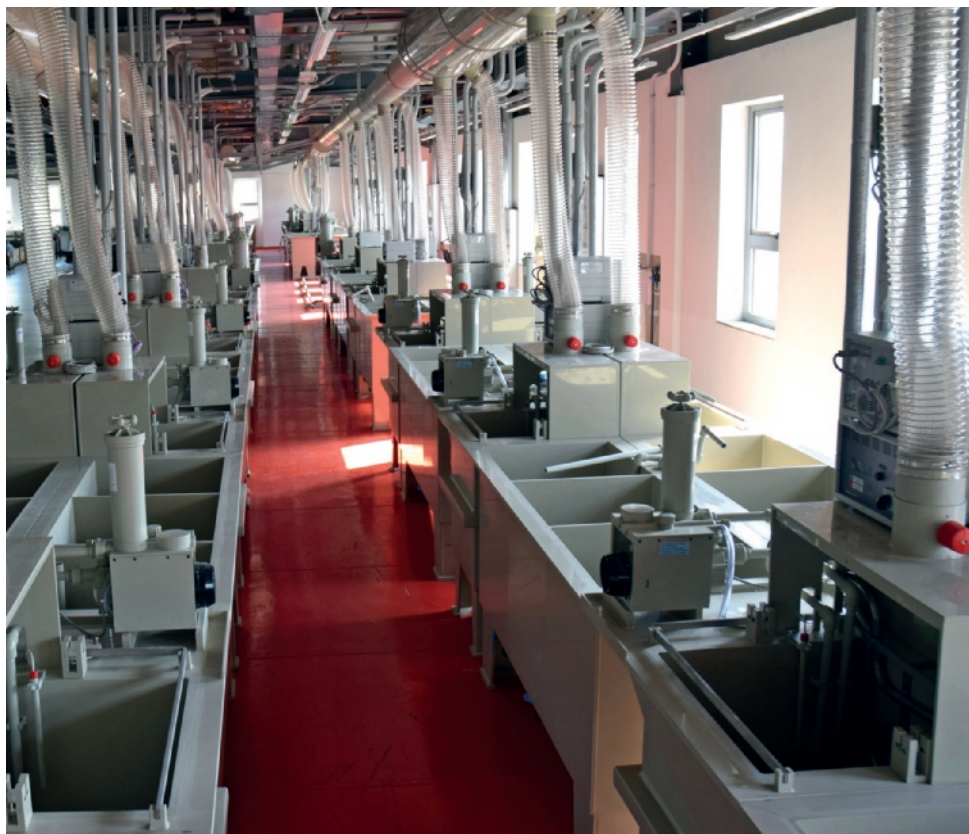
Vista del nuovo impianto a telaio statico in Bedin Galvanica, dove sono stati integrati i nuovi raddrizzatori R.C.V. Line Tech.
